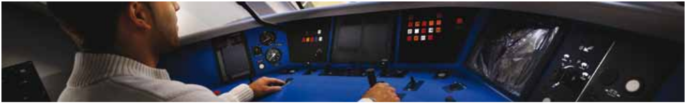
De Desiro-motorstellen worden geleverd met ETCS1 aan boord. Dat systeem leest ook TBL1+-gegevens.
