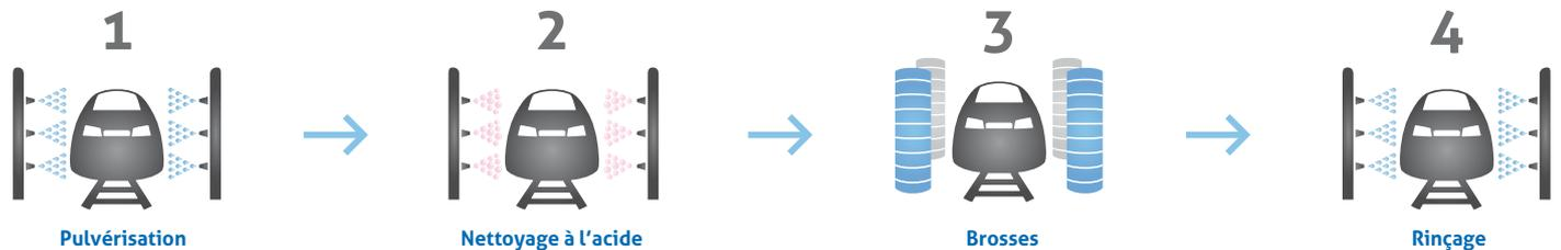
**1.** Le train est mouillé par pulvérisation. En hiver, lors de températures inférieures à 5°C, l'eau de lavage utilisée est à 60°C et ne peut donc pas geler.
