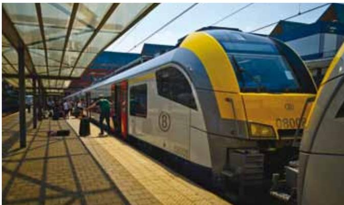
Pour une montée et une descente des passagers plus aisée et plus rapide, les voitures sont équipées de larges portes coulissantes.
