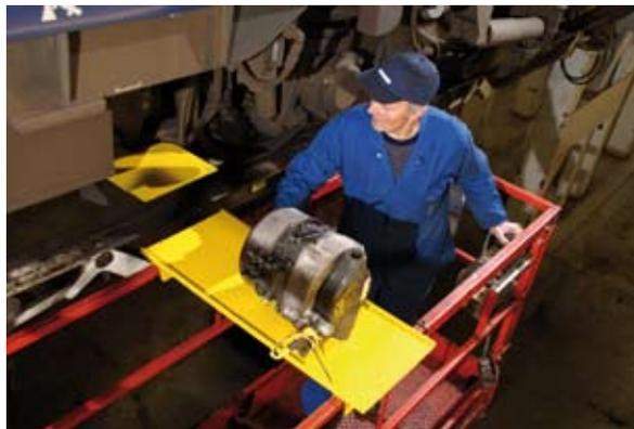
point une plate-forme de soutien sur mesure pour le cylindre de frein. Lorsqu'un cylindre de frein doit être remplacé, il est monté dessus et glissé ensuite sur une plate-forme qui est fixé à un élévateur. L'unité de frein peut ainsi être enlevée aisément et rapidement sur le côté puis remplacée.'
