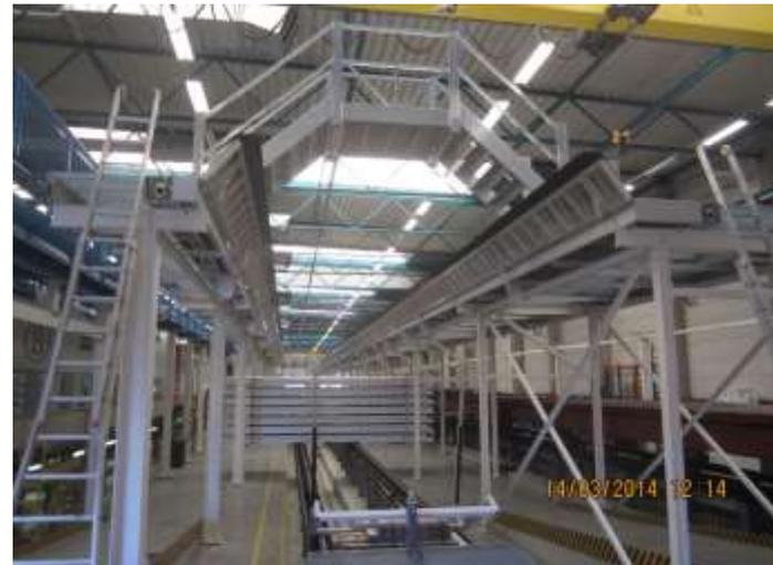
**Installation fixe pour le nettoyage et la vidange WC du matériel roulant en stationnement dans le faisceau V. (Coût : 1,9 Mio € en 2013)**
